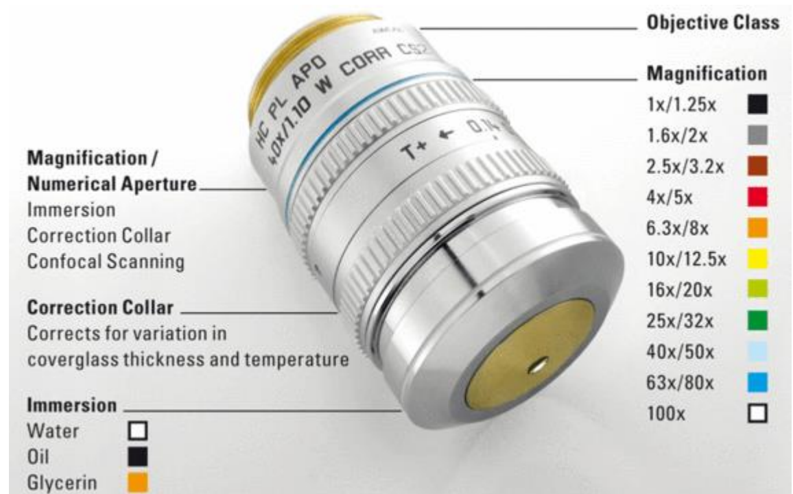
Ejemplo de un objetivo (Leica mycrosystems) con sus características detalladas
