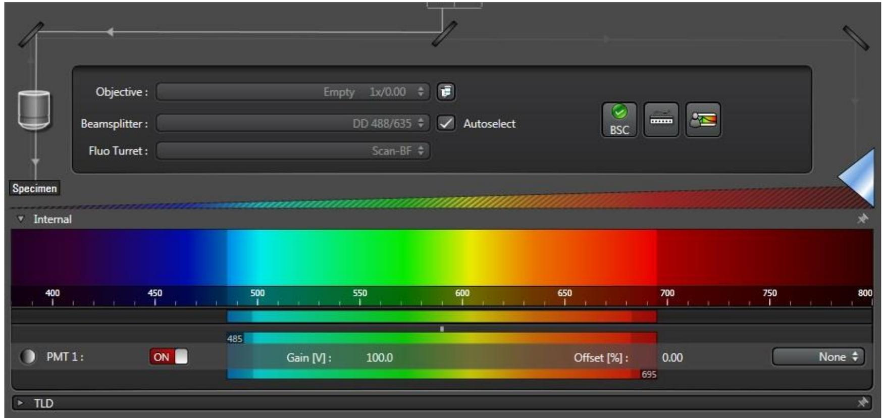
**Ajuste de la barra espectral:** para determinar las longitudes de onda de emisión captadas por el sistema. Debe ajustarse en función de los espectros de los fluorocromos empleados
